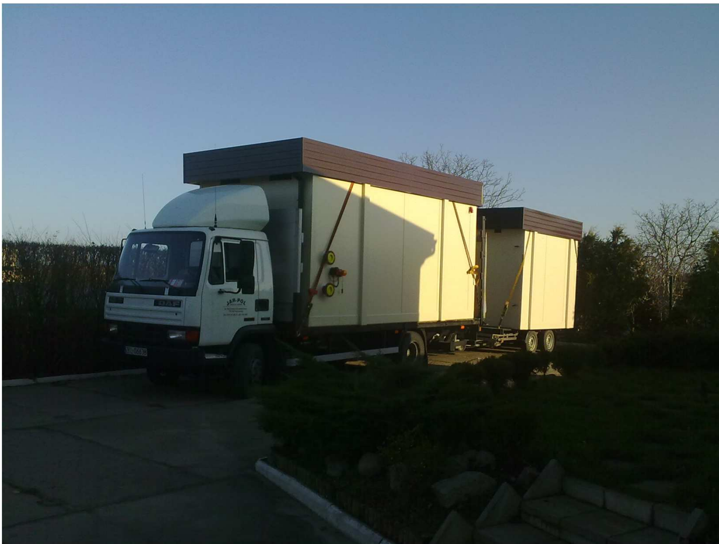
Rys. 9 Kotłownia kontenerowa przygotowana do transportu
